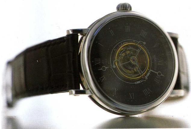
「ハルディマン H1 フライング」は、文字盤中央に、直径16.5mmという迫力あるフライング・トゥールビヨン・ケージを配置した斬新な顔を持つ。このようなレイアウトは、2番車の形状と機構に独自の工夫を凝らし、さらにリング状の極薄ホイールを9枚重ねることで実現した。ケース・バックからはトリプル・バレルが採用。パワーリザーブ38時間。手巻き。ムーブメントはオリジナルのCal.ZEN-A。18KPG、WGは890万円。Ptは980万円。
