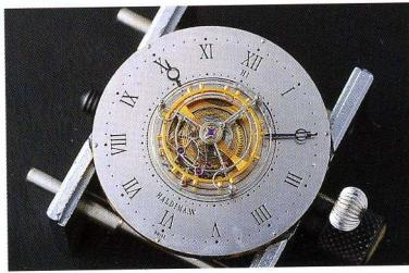
直径31.58mmのムーブメントの中央部に直径16.5mmのトゥールビヨン・ケージをおいたセンタートゥールビヨンは9つの極薄のリング状ホイールを重ね、ケージをその中心においている。またシースルー・パックを通してわかるように7時、9時、11時位置に3つの香箱を備え、9時位置の香箱が時、分針を動かし、7時と11時の香箱がトゥールビヨン・ケージを支える設計だ。
