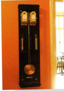
2000年に発表したH101レゾナンス・モダン。18世紀の時計師アンティード・ジャンヴィエがはじめて共振現象の原理を時計精度向上に採用し、クロックを製作した。それを現代に甦らせた。
